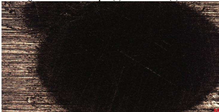
Figura 12 – Exemplos de crateras de desgaste obtidas nos ensaios. Ocorrência de desgaste microabrasivo por (a) riscamento e (b) rolamento
