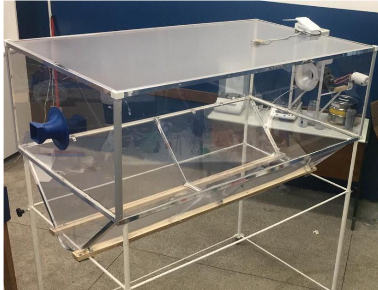
Figura 9 – Separador Gravitacional com as chapas fixadas
