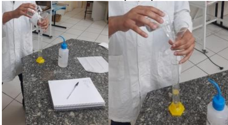
Figura 5 – Adicionando a massa de pó de pedra no volume de água
