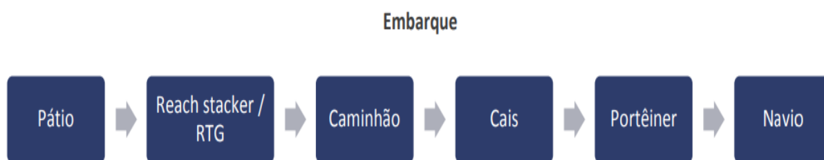
Figura 5 – Fluxograma de Operação de Contêineres no TCP
