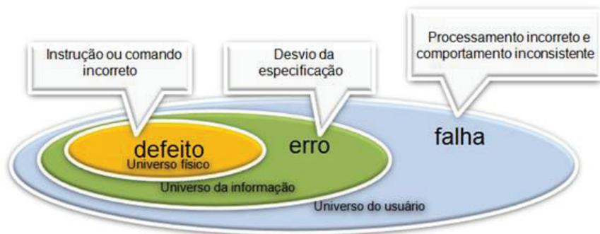
**Figura 1: Diferença entre falha, erro e defeito**
