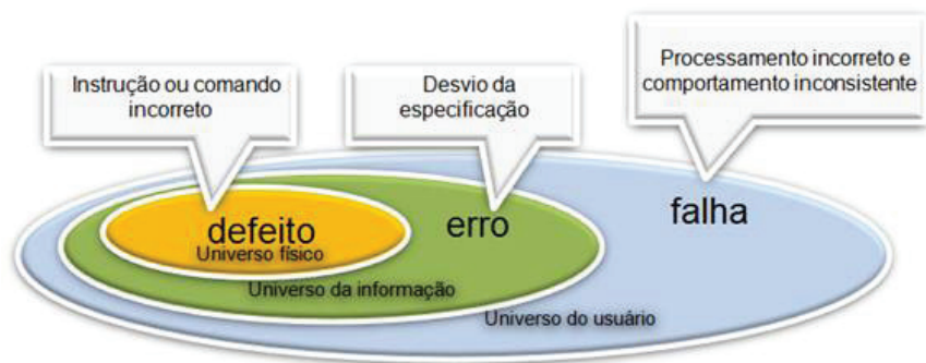
Figura 1: Diferença entre falha, erro e defeito
