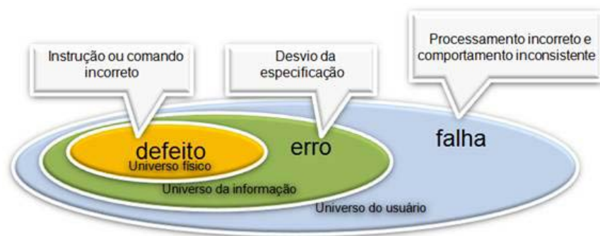
Figura 1: Diferença entre falha, erro e defeito
