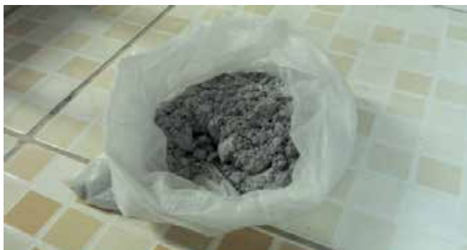
Figura 11 – Material abrasivo ( \text{Al}_2\text{O}_3 ) utilizado nas preparações das lamas abrasivas
