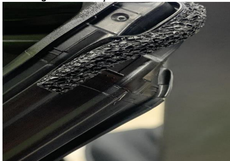
Figura 3: Guarnição com descolamento
