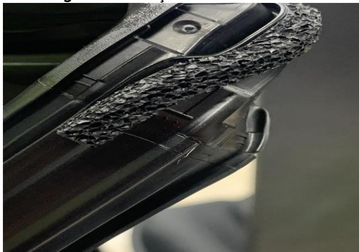
Figura 3: Guarnição com descolamento
